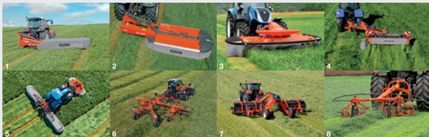
1. Schijvenmaaier - 2. Trommelmaaier - 3. Front maaiknikschudder - 4. Getrokken maaiknikschudder - 5. Schijvenmaaier-triplecombinatie - 6. Cirkelhark - 7. Bandhark - 8. Harkschudder
