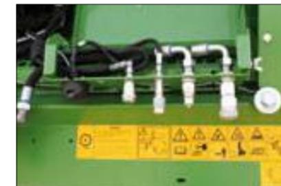
Werkzeuglos Schnellkupplungen der Hydraulikanschlüsse
