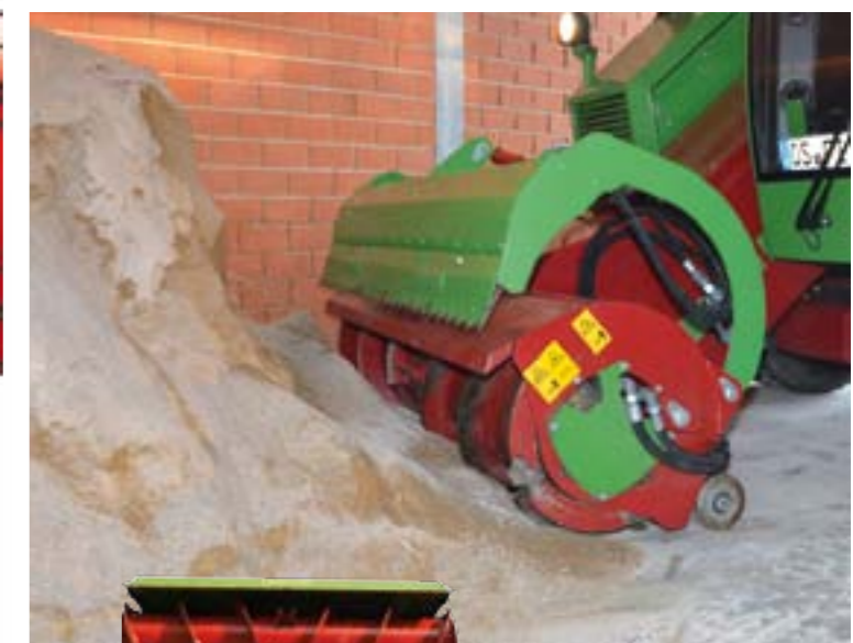
Aufnahme feiner Schüttgüter über die Förderwalze mit hochgeklapptem Schneidschild
