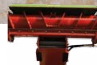
Aufnahme feiner Schüttgüter über die Förderwalze mit hochgeklapptem Schneidschild
