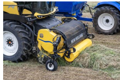
De diameter van de rolwindgeleider is 450 mm voor veelzijdige gewasbesturing in alle zwadgroottes, -afmetingen en -samenstellingen.
