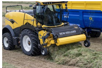
Gebeurt automatisch: De opraper gaat omhoog en schakelt uit, waarbij het rolwindscherm gedeeltelijk wordt opgetild, wanneer een verstopping of vreemde voorwerpen worden aangetroffen.
