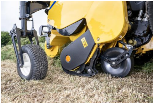
Slipschoen- en rolinstallatie op 3,0m-eenheid.
